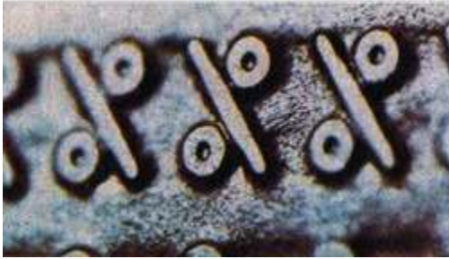
Tipičen izsek z bobna vrstičnega tiskalnika, z vgraviranimi znaki %.
