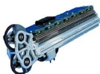
Celoten modul (tiskalna glava) matrično-vrstičnega tiskalnika A3
